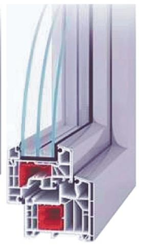
PASIV AC 85 - 6Ti komorový 85mm profil AL clip 3 těsnění, izolační trojsklo Ug = 0,5/0,6 W.m-2.K-1
